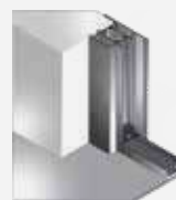
F: Montage in de dag met afdeklijst buiten
